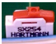
Schakelstand rechts (afleveringstoestand)
